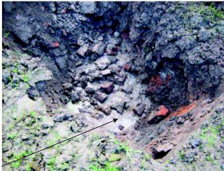
Bild 5: Schichtwassereintritt im Schurf
